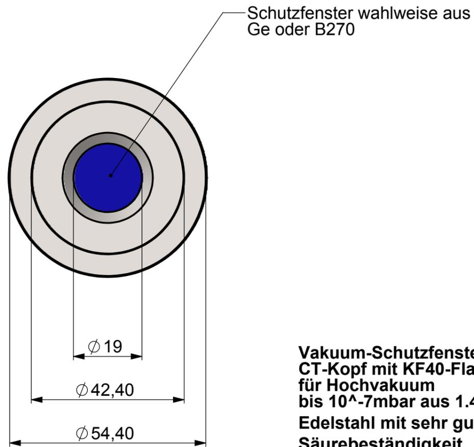
**Vakuum-Schutzfenster für CT-Kopf mit KF40-Flansch für Hochvakuum bis  $10^{-7}$  mbar aus 1.4404 Edelstahl mit sehr guter Säurebeständigkeit**
